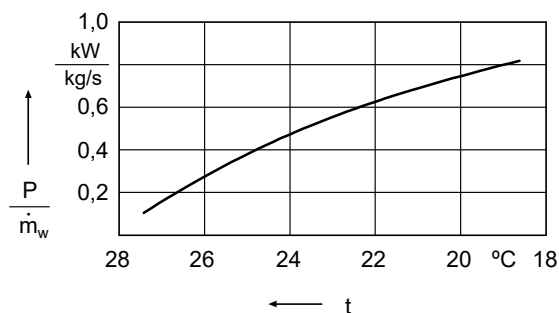
Erzielbare elektrische Leistung P in Abhängigkeit der Verdampfungs- temperatur t für 1 kg Meerwasser / s ( \eta_{\text{eff}} = 0,5 \cdot \eta_C ; t_2 = 7^\circ\text{C} )
